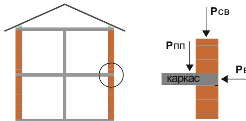
$P_{cb}$  – нагрузка от собственного веса стены,  $P_{pp}$  – нагрузка от перекрытий и покрытий,  $P_v$  – ветровая нагрузка.
